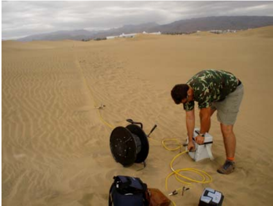
Investigadores trabajando con sismica de reflexión
